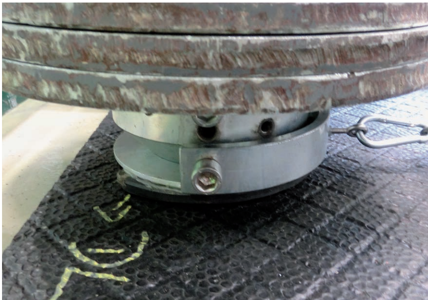
Bild 2: Rutschfestigkeitsmessung nass, mit Barhuf
