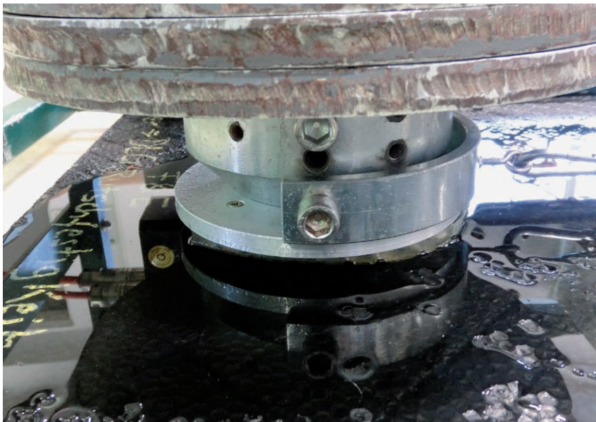
Bild 2: Rutschfestigkeitsmessung nass, mit Barhuf
