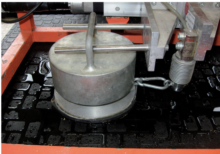
Bild 3: Rutschfestigkeitsmessung nass, mit Hufeisen
