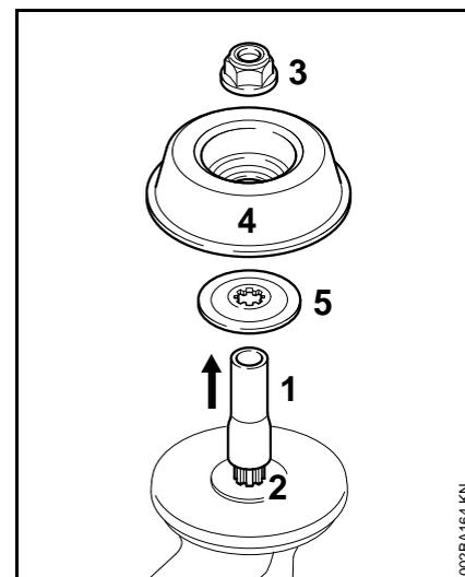
Dazu sind je nach Ausführung des Schneidwerkzeuges zusätzlich Mutter (3), Lauffeller (4) und Druckscheibe (5) notwendig.
