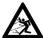
Gelände prüfen: Feste Gegenstände – Steine, Metallteile o. Ä. können weggeschleudert werden – auch über 15 m – **Verletzungsgefahr!** – und können das Schneidwerkzeug sowie Sachen (z. B. parkende Fahrzeuge, Fensterscheiben) beschädigen (Sachbeschädigung).
