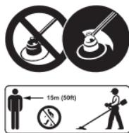
Odmrštěné předměty mohou způsobit těžká poranění. Pracovat pouze se správně namontovaným ochranným krytem pro vyžínač nebo křivoňořez a žaci hlavu. Dodržovat minimální vzdálenost 15 m (50 stop) od osob, které se zdržují v okolí.
