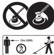
Alvorlige personskader kan forårsakes av gjenstander som slynges ut. Det må kun arbeides med riktig montert beskyttelse for trimmeren eller ryddesagen og klappehodet. En minsteavstand på 15 m (50 fot) skal overholdes til omkringstående personer.
