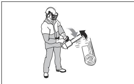
Verwenden Sie die Kettenbremse als Feststellbremse, wenn Sie das Gerät starten und sich über kurze Strecken bewegen. Dadurch reduzieren Sie das
