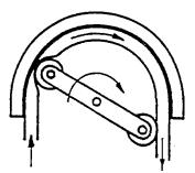
eingeschlossen sind. Umlaufende Rollen drücken den Dosierschlauch gegen die Gehäusewandung, wodurch die Flüssigkeit im Schlauch vor den Rollen herausgedrückt und dahinter gleichzeitig nachgesaugt wird. Sie ist außerordentlich funktionssicher und leicht zu bedienen.
