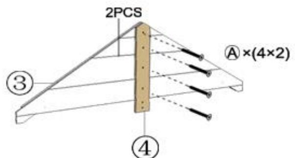
**Schritt 2:** Verbinden Sie nun den Dachabschluss (3) mit der Vorderseite (1) des Hauses. Die Vorderseite erkennen Sie an der Aussparung für die Tür. Nutzen Sie hierfür vier Schrauben (A). Wiederholen Sie diesen Schritt auch für die Rückwand (2).
