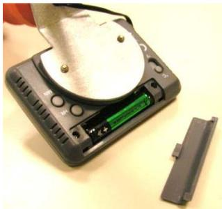
Abbildung 2: Batterie einlegen
