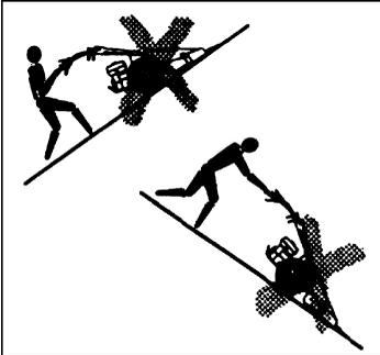
**! Arbeiten Sie niemals hangabwärts, da die Maschine ins Rutschen geraten kann.** Versuchen Sie nicht, die ins Rutschen geratene Maschine festzuhalten. Die Maschine ist zu schwer, als dass sie gehalten werden könnte. Steuern Sie durch Lenkbewegungen die Maschine möglichst quer zum Hang. Lassen Sie den Sicherheitshebel los, damit die Sicherheitseinrichtung aktiviert wird.
