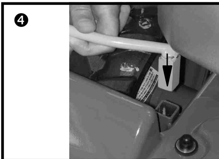
❹ Schwadtuchstange mit dem aufgefädelten Schwadtuch in das Vierkantrrohr am Gestrüppmäher einstecken
