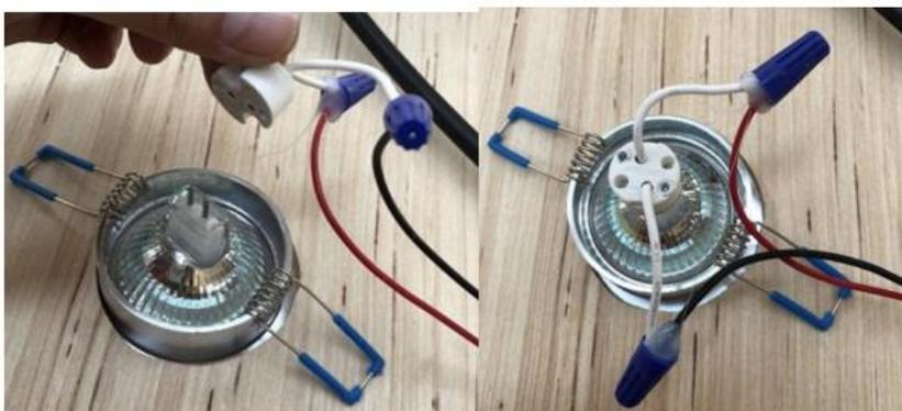
Setzen Sie die Lampe in den Deckel ein. Verbinden Sie das Kabel der Lampe mit der Glühbirne.
