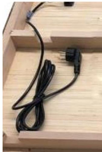
Auf dem Deckel befindet sich eine Verkabelung für die Lampen, die in einem 220V-240V Steckdose eingesteckt werden muss.
