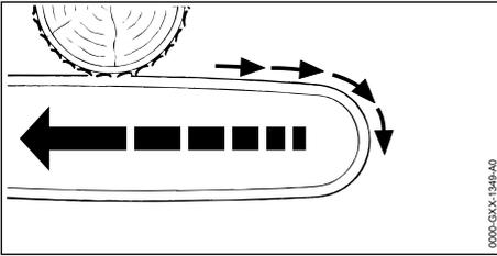
Wenn mit der Oberseite der Führungsschiene gearbeitet wird, wird die Motorsäge in Richtung des Benutzers gestoßen.
