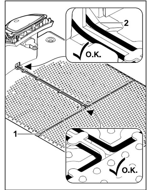
Begrenzungsdraht (1) in Kabelführungen der Bodenplatte einlegen und durch Sockel (2) fädeln.
