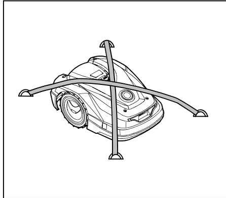
Mähroboter auf der Ladefläche sichern. Dazu Gerät wie abgebildet mit geeigneten Befestigungsmitteln (Gurte, Seile) fixieren.
