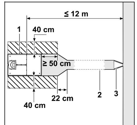
Damit das Ein- und Ausdocken ordnungsgemäß funktionieren, kann die Dockingstation (1) wie abgebildet mit einer Gasse (2) installiert werden. Die Bereiche um die Dockingstation und außerhalb des Begrenzungsdrahts müssen eben und frei befahrbar sein. Hügel oder Vertiefungen beseitigen.
