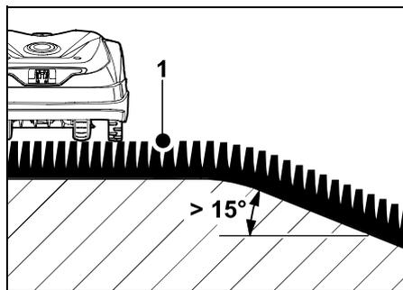
Befindet sich in der Mähfläche ein abfallender Bereich mit einem Gefälle  $> 15^\circ$ , in dem ein Begrenzungsdraht verlegt werden soll, wird empfohlen, den Begrenzungsdraht (1) wie abgebildet in der ebenen Fläche oberhalb der Geländekante zu verlegen. Die Geländekante und der abfallende Bereich werden nicht gemäht.
