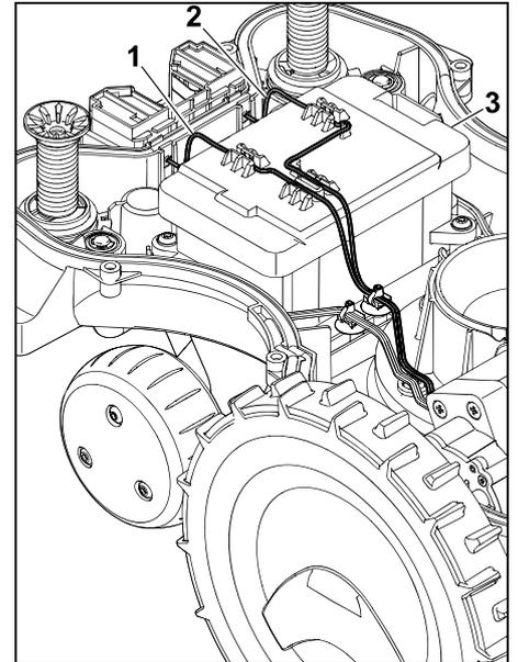
Kabel (1) und Kabel (2) aus den Kabelführungen entnehmen und Akku (3) entnehmen.
