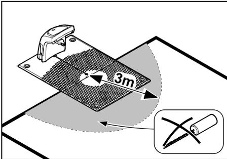
Das AKM 100 mit einem Mindestabstand von 3 m zur Dockingstation installieren.
