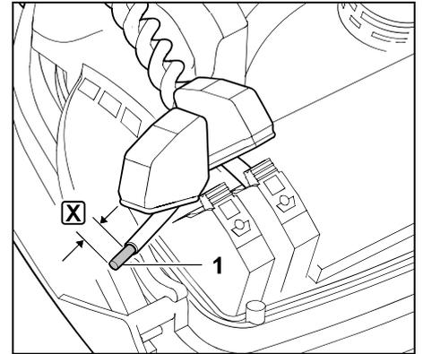
Rechtes Drahtende (1) mit einem geeigneten Werkzeug auf die angegebene Länge **X** abisolieren und Drahtlitze verdrillen.
