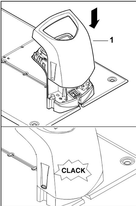
Abdeckung (1) auf Dockingstation aufsetzen und einrasten lassen – keine Kabel einklemmen.
