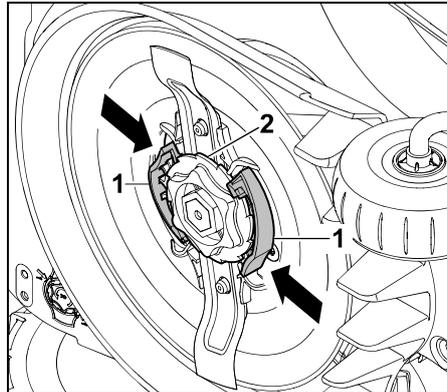
Beide Laschen (1) an der Mitnehmerscheibe mit einer Hand eindrücken und halten. Fixiermutter (2) mit der anderen Hand ausdrehen. Mähmesser zusammen mit Fixiermutter entnehmen.
