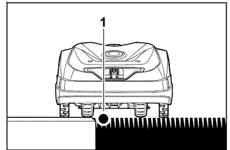
Entlang von befahrbaren Hindernissen wie Terrassen und befahrbaren Wegen kann der Begrenzungsdraht (1) **ohne Abstand** verlegt werden. Der Mähroboter fährt dann mit einem Hinterrad außerhalb der
