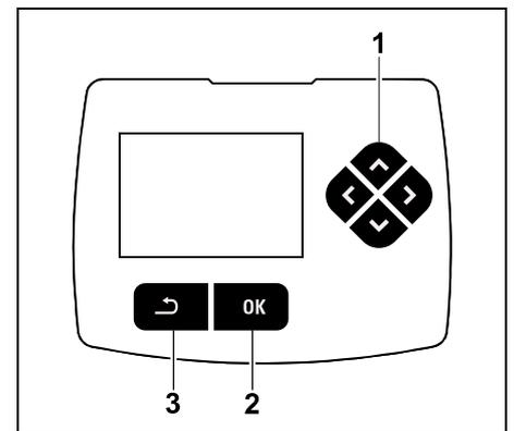
Das Steuerkreuz (1) dient zur Navigation in den Menüs, mit der OK-Taste (2) werden Einstellungen bestätigt und Menüs geöffnet. Mit der Zurück-Taste (3) können Menüs wieder verlassen werden.
