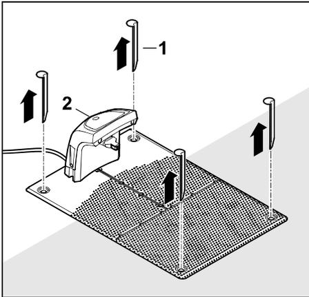
Heringe (1) herausziehen, Dockingstation (2) mit dem angeschlossenen Netzteil aus der Rasenfläche entfernen, gründlich reinigen (mit einem feuchten Tuch) und einlagern.
