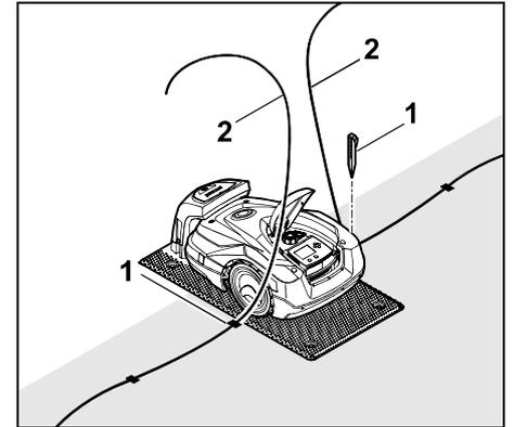
Den letzten Fixiernagel (1) links bzw. rechts neben der Bodenplatte, direkt neben dem Drahtauslass einschlagen. Begrenzungsdraht (2) auf ca. 1,5 m freie Länge abschneiden.
