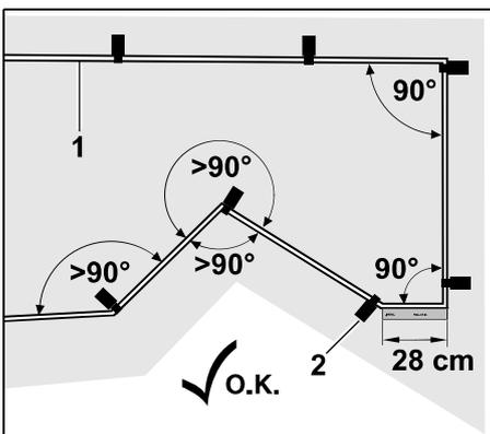
Die Verlegung in spitzen Winkeln (kleiner als 90°) ist zu vermeiden. In spitz zulaufenden Rasenecken Begrenzungsdraht (1) wie abgebildet mit Fixiernägeln (2) am Boden befestigen. (⇒ 12.6)
