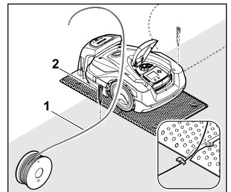
Begrenzungsdraht (1) **links** oder **rechts** neben der Bodenplatte, direkt neben einem Drahtauslass mit einem Fixiernagel (2) am Boden befestigen.
