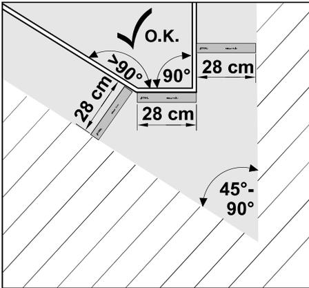
In spitz zulaufenden Rasenecken ( $45^\circ - 90^\circ$ ) wird der Begrenzungsdraht wie abgebildet verlegt. Die beiden Winkel müssen einen Abstand von mindestens **28 cm** haben, damit der Mähroboter den Rand abfahren kann.
