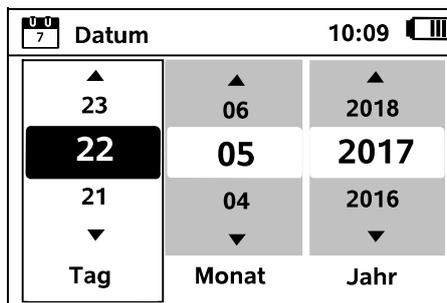
Aktuelles Datum mit Hilfe des Steuerkreuzes einstellen und mit der OK-Taste bestätigen.
