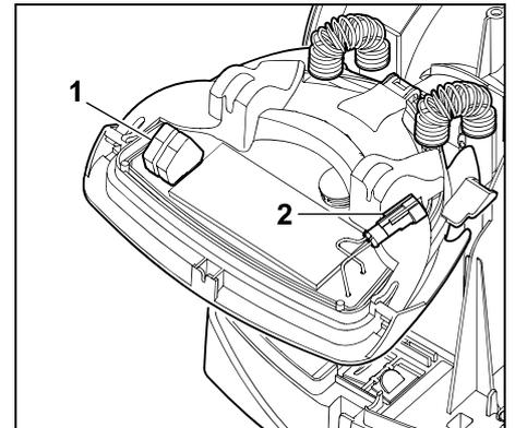
Die Anschlüsse für den Begrenzungsdraht (1) und das Stromkabel (2) sind bei geschlossenem Panel gegen Witterungseinflüsse geschützt.
