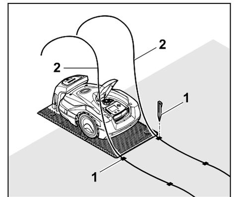
Den letzten Fixiernagel (1) links bzw. rechts hinter der Bodenplatte, direkt neben dem Drahtauslass einschlagen. Begrenzungsdraht (2) auf ca. 2 m freie Länge abschneiden.
