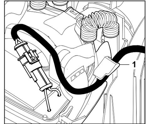
Stromkabel durch die Kabelführung (1) am Panel führen.
