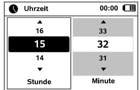
Aktuelle Uhrzeit mit Hilfe des Steuerkreuzes einstellen und mit der OK-Taste bestätigen.
