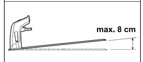
Die Dockingstation darf maximal 8 cm nach hinten und 2 cm nach vorne geneigt sein.
