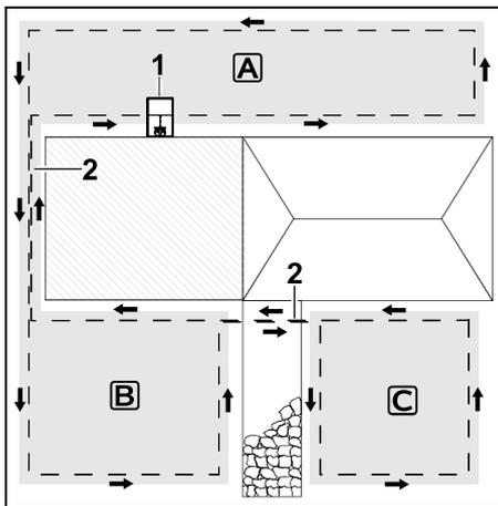
Die Dockingstation (1) wird in der Mähfläche **A** installiert, diese wird nach Mähplan vollautomatisch bearbeitet. Die Nebenflächen **B** und **C** sind mit Verbindungsstrecken (2) mit der Mähfläche **A** verbunden. In allen Flächen muss der Begrenzungsdraht in derselben Richtung verlegt werden – Begrenzungsdraht in den Verbindungsstrecken nicht überkreuzen.
