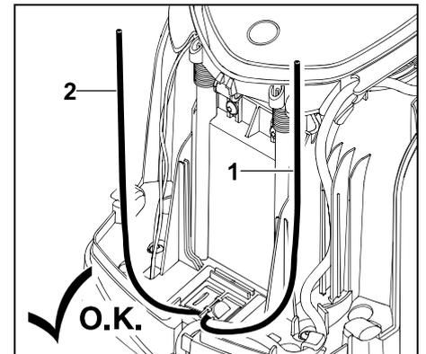
Linkes Drahtende (1) und rechtes Drahtende (2) auf dieselbe Länge kürzen. Länge vom Drahtauslass bis zum Drahtende: **40 cm**
