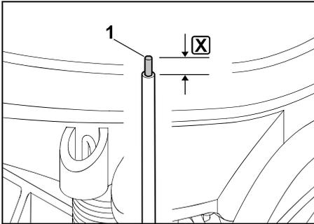
Linkes Drahtende (1) mit einem geeigneten Werkzeug auf die angegebene Länge **X** abisolieren und Drahtlitze verdrillen.
