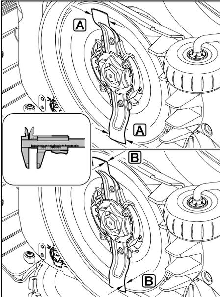
**Messerbreite A** und **Messerstärke B** mit einem Messschieber prüfen. Ist das Mähmesser an einer Stelle schmaler als **25 mm** oder dünner als **1,3 mm**, muss es ersetzt werden.
