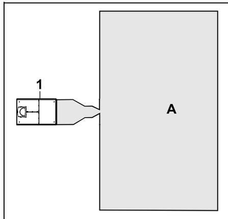
Die Dockingstation (1) wird außerhalb der Mähfläche (A) installiert.
