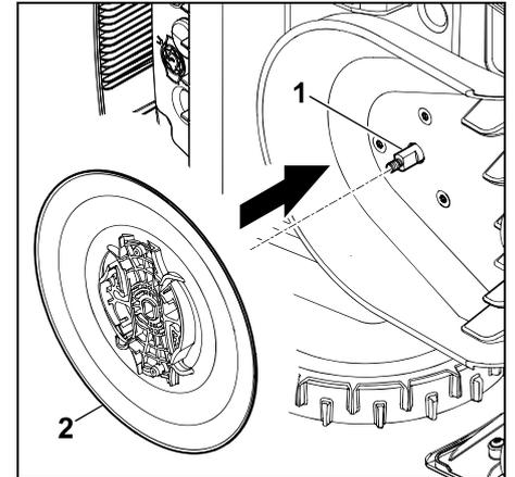
Messerwelle (1) und Aufnahme an der Mitnehmerscheibe (2) gründlich reinigen. Mitnehmerscheibe bis zum Anschlag auf die Messerwelle schieben.
