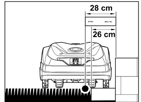
Begrenzungsdraht mit 28 cm Abstand vom Hindernis entfernt verlegen. Damit die Rasenkante vollständig gemäht wird, müssen die Randsteine mindestens 26 cm breit sein. Werden breitere Randsteine verlegt, wird die Rasenkante noch exakter bearbeitet.
