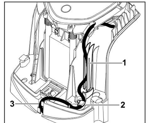
Stromkabel wie abgebildet in die Kabelführung (1) eindrücken und weiter durch die Zugentlastung (2) und den Kabelkanal (3) zum Netzteil führen.
