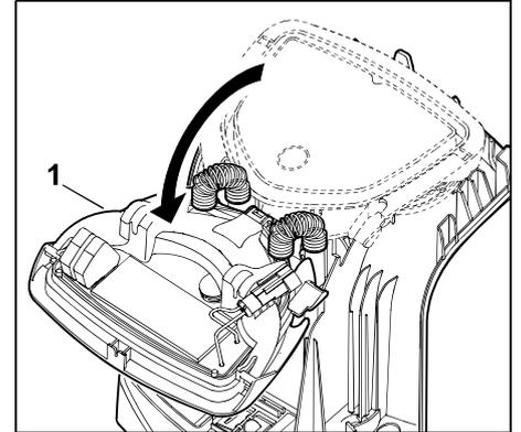
Panel (1) nach vorne aufklappen. Panel in aufgeklappter Position halten, weil es aufgrund der Scharnierfedern selbständig zuklappt.
