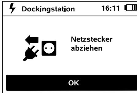
Stecker des Netzteils vom Stromnetz trennen, anschließend OK-Taste drücken. **OK**
