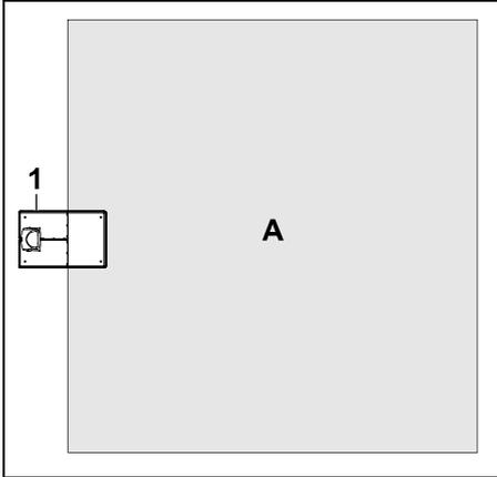
Die Dockingstation (1) wird innerhalb der Mähfläche (A), direkt am Rand installiert.
