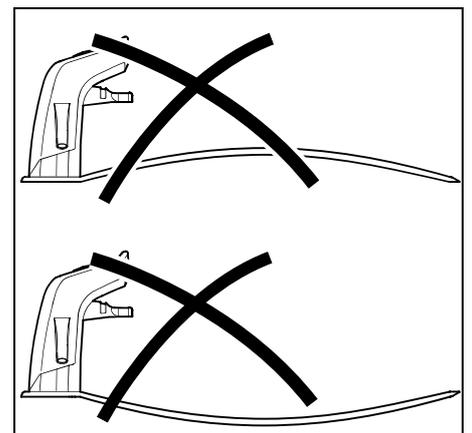
Bodenplatte niemals durchbiegen. Unebenheiten unter der Bodenplatte sind zu beseitigen, damit sie vollständig aufliegen kann.
