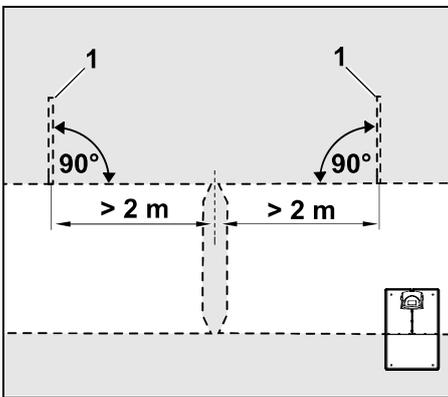
Links und rechts neben der Gasseneinfahrt sind zwei Suchschleifen (1) in einem Winkel von 90° zum Begrenzungsdraht zu installieren,
