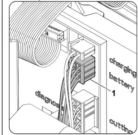
Kabelstecker (1) (battery) abziehen.
