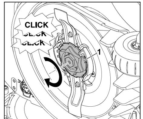
Fixiermutter (1) bis zum Anschlag aufschrauben. Während des Festziehens sind mehrere Click-Geräusche hörbar. Den sicheren Sitz des Mähmessers durch vorsichtiges Rütteln kontrollieren.
