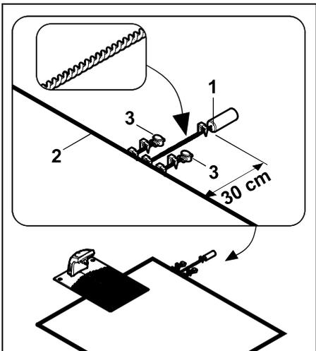
AKM 100 (1) mit 30 cm Abstand außerhalb der Mähfläche mit einem Fixiernagel befestigen. Drahtenden bis zur Mähfläche verdrillen und mit einem Fixiernagel befestigen.
