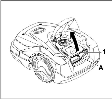
Klappe (1) am Haltepunkt (A) nehmen und durch einen leichten Ruck nach oben lösen. Klappe bis zum Anschlag öffnen.
