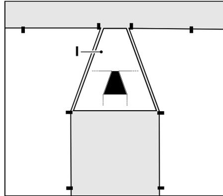
Zur Installation der trichterförmigen Ein- und Ausfahrt auch die mitgelieferte Gassenschablone (I) verwenden.
