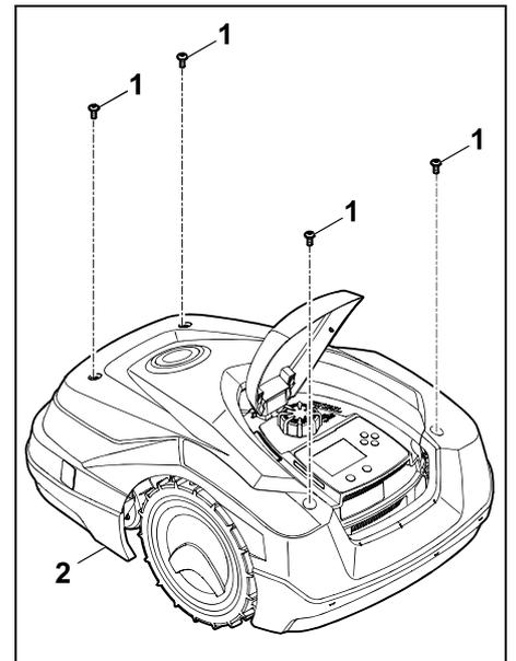
Schrauben (1) an der Abdeckung (2) ausdrehen und entnehmen. Abdeckung (2) nach oben abziehen.
