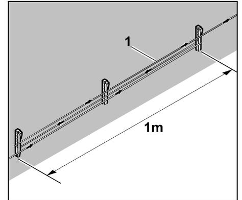
Begrenzungsdraht (1) über eine Länge von ca.  $1\text{ m}$  zwischen 2 Fixiernägeln wie abgebildet verlegen. Drahtreserve in der Mitte mit einem weiteren Fixiernagel am Boden festmachen.
