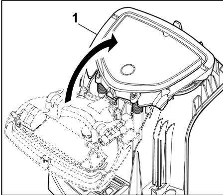
Panel (1) nach hinten zuklappen – keine Kabel einklemmen.
