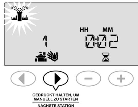
6. Um den Test abzubrechen, Steuergerät der Wählscheibe drei Sekunden lang in die Position **AUS** drehen und anschließend zurück in die Position **AUTOMATISCHER BETRIEB**.
