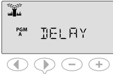
5. Bei einer Verzögerung zwischen einzelnen Stationen die Taste **Nächste Station** drücken, um die Bewässerung für die Station zu unterbrechen und zu starten.
