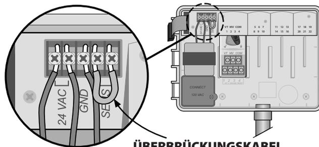
2. Kabel des Regensensors durch eine Ausbrechöffnung an der Unter- oder Rückseite des Aggregats führen.
