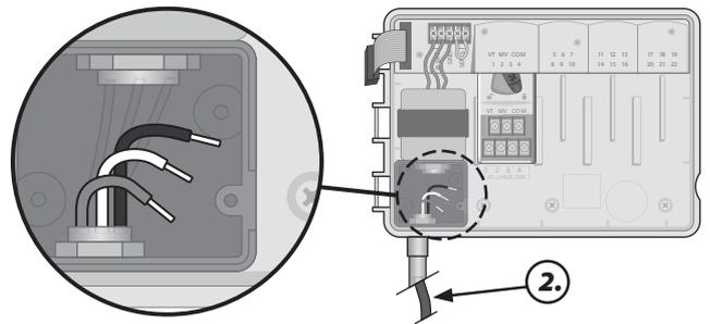
**3.** Kabel der externen Stromquelle (zwei Strom- und ein Massekabel) an den vorhandenen Stecker im Klemmenkasten anschließen..
