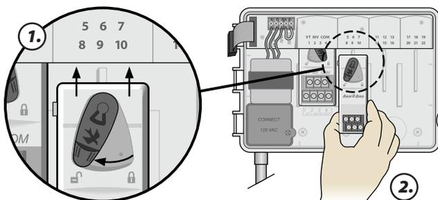
3. Modul nach oben schieben, bis es sicher im Schacht sitzt.
