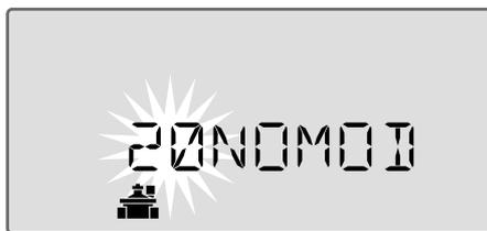
Am Bildschirm wird „20NOMOD“ angezeigt, wobei die „20“ blinkt, um anzuzeigen, dass Station 20 (genauso wie 21-22) nicht verwendet wird und nicht zur Programmierung zur Verfügung steht.
