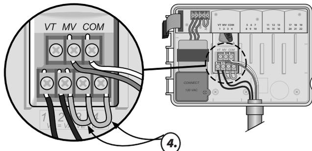
**ACHTUNG:** Um zu verhindern, dass die Pumpe trockenläuft, verfahren Sie wie folgt bei allen nicht verwendeten Stationen (Modul installiert aber nicht mit einem Stationskabel verbunden):
