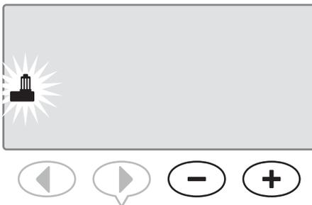
Das Symbol für den Regensensor erscheint im Display unter **AUTOMATISCHER BETRIEB** oder **AUS**, wenn der Regensensor auf **UMGEHEN** gesetzt ist.
