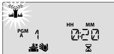
6. Um die manuelle Bewässerung abzubrechen, Steuergerät der Wählscheibe drei Sekunden lang in die Position **AUS** drehen und anschließend zurück in die Position **AUTOMATISCHER BETRIEB**.
