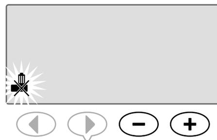
**!** **HINWEIS:** Das Symbol **SENSOR UMGEHEN** wird am Display in **AUTOMATISCHER BETRIEB** angezeigt, wenn **UMGEHEN** ausgewählt ist.
