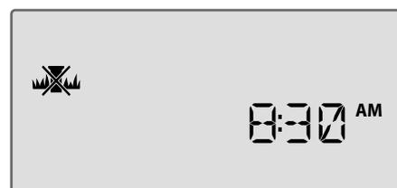
Programmierte Bewässerungszeitpläne und aktuelles Datum/Uhrzeit bleiben permanent im Speicher gespeichert, während das Steuergerät **AUS** ist oder bei einem unerwarteten Stromausfall.
