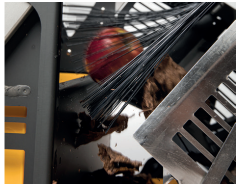
Die Laubbürste zum Abscheiden von Laub
