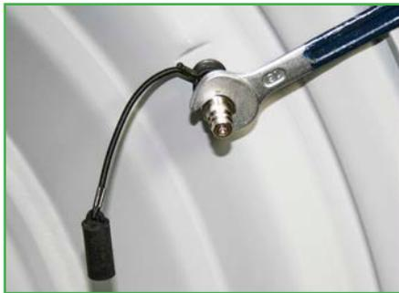
Der PTG-Aufschraubnippel, wird einmalig auf das Reifenventil aufgeschraubt, der Ventileinsatz wird zuvor entfernt (größerer Luftdurchlaß).
