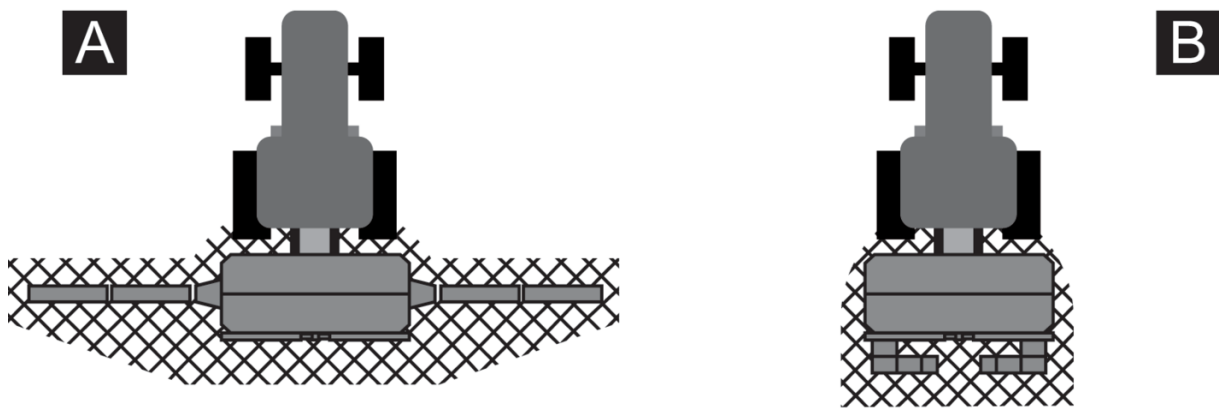
Abb. 1: Gefahrenbereich bei angehängten Geräten
