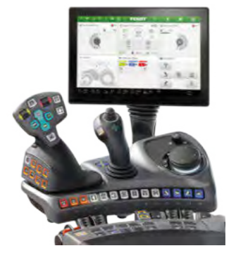
Power+ Setting 2 • 3L-Joystick • Ein Rockerpaar (Linearmodul) zur Bedienung der Hydraulikventile
