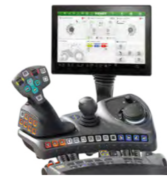
Power+ Setting 1 • Kreuzschalthebel • Ein Rockerpaar (Linearmodul) zur Bedienung der Hydraulikventile
