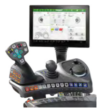
Power Setting 2 • Kreuzschalthebel • Kein Rockerpaar (Linearmodul) zur Bedienung der Hydraulikventile
