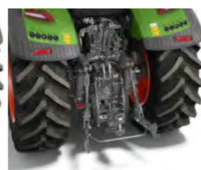
Heckkraftheber mit Schnellfanghaken und Rub Blocks (AU, Südafrika, Osteuropa)
