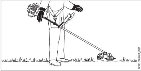
Das Schneidwerkzeug muss leicht auf dem Boden aufliegen.
