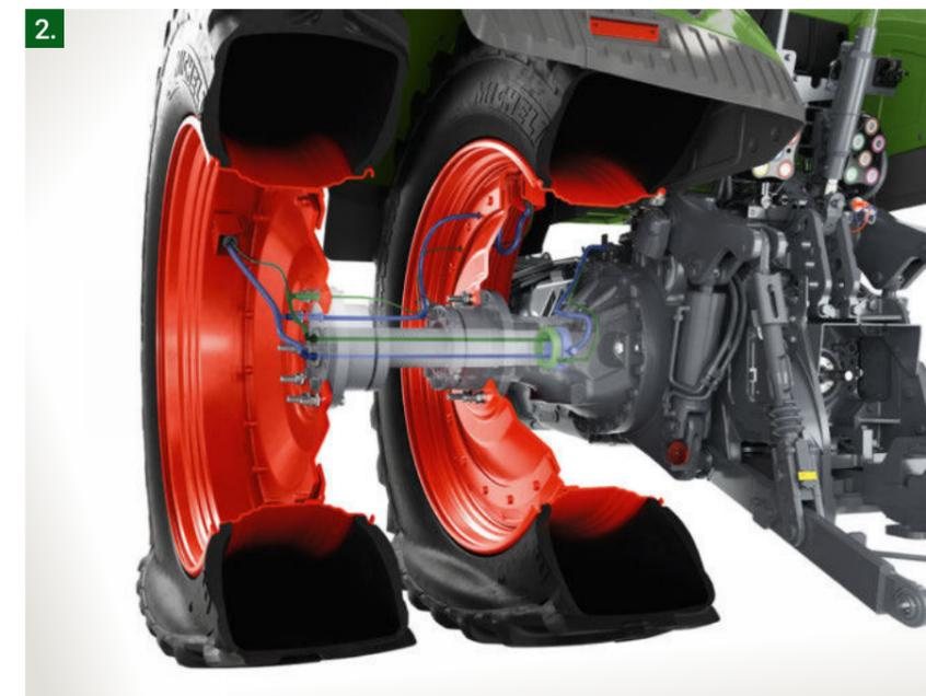
**2. VarioGrip für Flansch- und Stummelachse**
