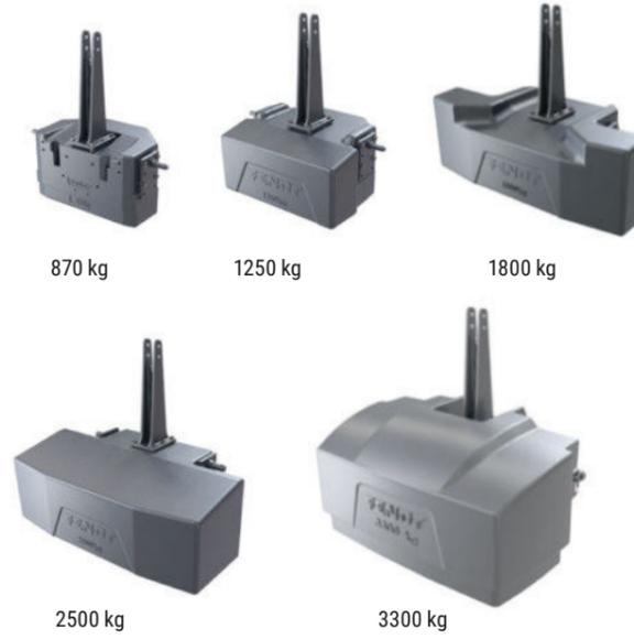
Möglichkeiten Ballastierung Hinterachse:
