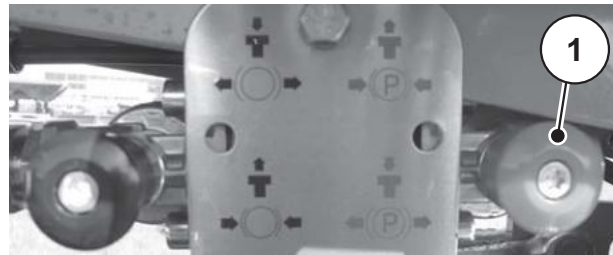
Bild 8.1: Feststellbremse lösen (pneumatische Bremsanlage)
