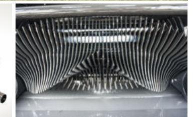
XtraCut25 Rotor - Mit Schneidwerk: bis zu 25 Messer
