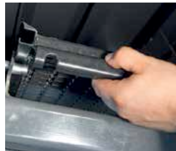
Ausbau der Siebe
