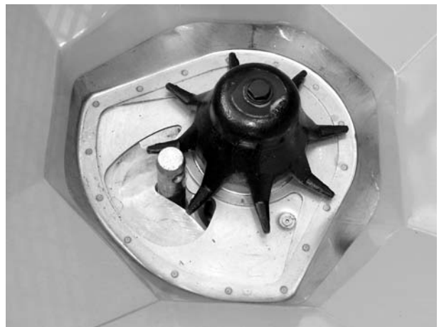
Bild 10.18: Unterlenkerbolzen in Dosieröffnung
