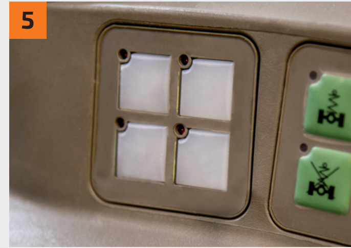
5 Klebereste komplett vom grauen Kunststoff entfernen, da sonst die neue Folie uneben aufliegt. Remove adhesive residues completely from the grey plastic, otherwise the new film will be uneven
