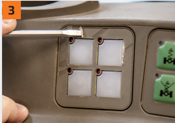
3 Klebereste mit Hilfe eines Schraubendrehers lockern und anheben ... Use a screwdriver to loosen and lift the adhesive residues ...
