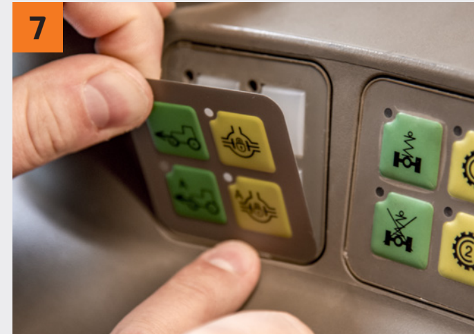
7 Unten gerade an der Kante ansetzen und nach oben hin anbringen und fest drücken. Position straight on the edge at the bottom, attach to the top and press firmly.
