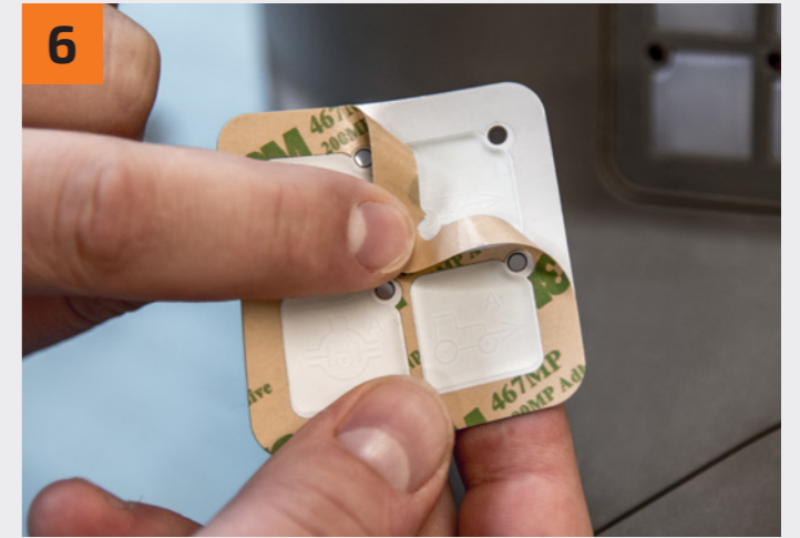
6 Klebeschutzfolie von der neuen Coverfolie abziehen. Remove the adhesive protection foil from the new cover foil.
