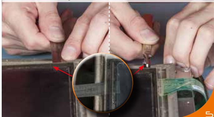
Lösen Sie die vier Schrauben am Display.
