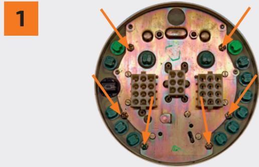
1 Entfernen Sie die sechs Gehäuseschrauben.
