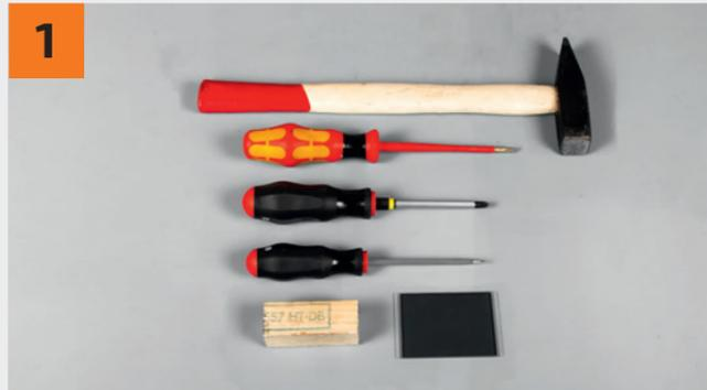
Die benötigten Werkzeuge und Ersatzteile (v. oben nach unten): Hammer, Schraubendreher (bitte kein Akkuschauber), Holzklötz, Display.
