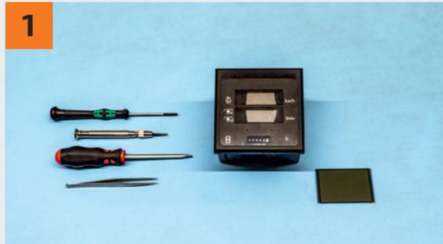
1 Die benötigten Werkzeuge: passende Schraubenzieher und eine Pinzette.
