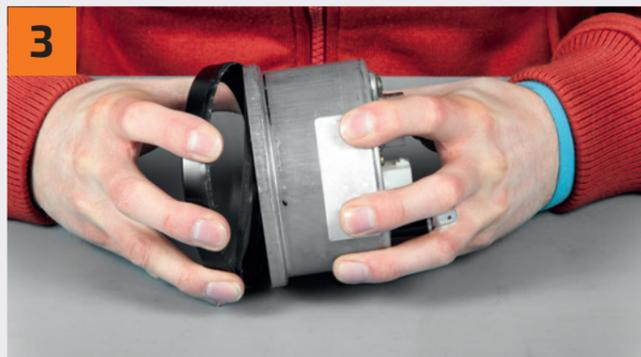
Lösen Sie die Gehäuseabdeckung vom Gehäuse – **Vorsicht mit den scharfen Kanten!**
