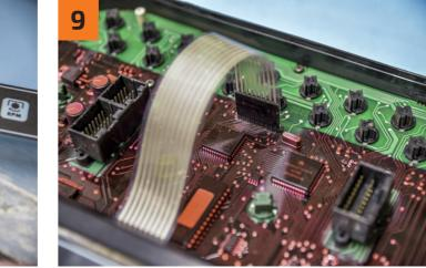
Führen Sie das Flachbandkabel durch die Aussparung und setzen Sie das Frontcover wieder auf.
