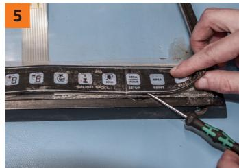
Entfernen Sie die alte Folientastatur mit einem flachen Schraubendreher oder einem Plastikschaber.
