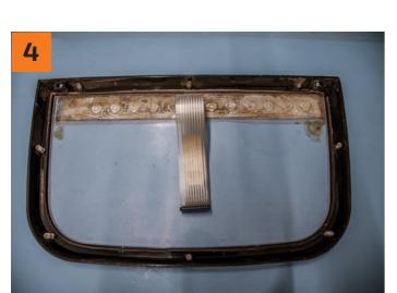
Ziehen Sie das Flachbandkabel durch die Aussparung und entfernen Sie dann die Frontabdeckung des Instrumentenbrettes.
