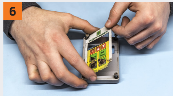
Entfernen Sie die Folientastatur vollständig. Remove the membrane keypad completely.
