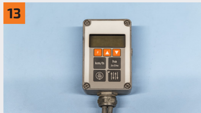
Deckel aufsetzen und die Schrauben festziehen. Die Reparatur ist nun fertig. Fit the cover and tighten the screws. The repair is now finished.
