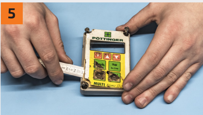
Nun die defekte Folientastatur mit dem Lineal vom Deckel lösen. Now remove the defective membrane keyboard from the lid with the ruler.
