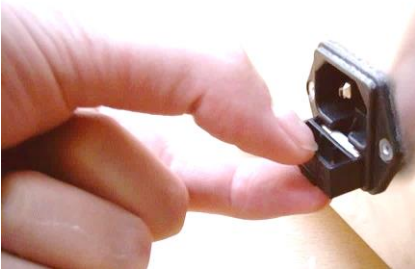
Abbildung 9: Austausch der internen Sicherung
