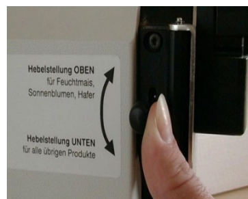
Abbildung 4: Labomil und Messzellenunterteil, Einstellung des seitlichen Hebels an der Labomil
