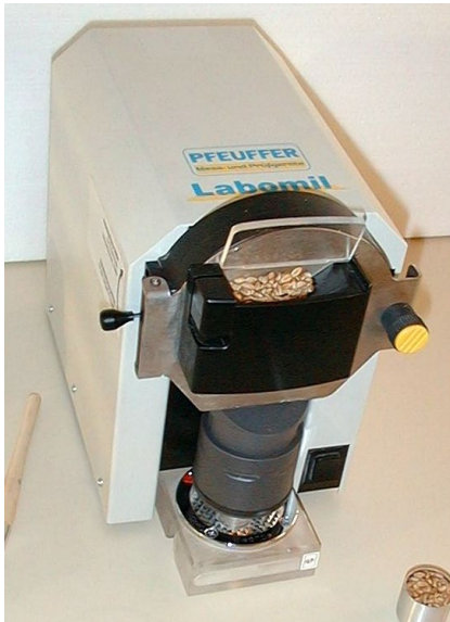
Abbildung 4: Labomil und Messzellenunterteil, Einstellung des seitlichen Hebels an der Labomil
