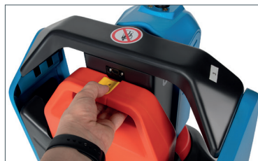
Sekundenschneller Akkuwechsel – mit einem Handgriff
