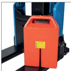
Optional: Wechselakku mit 20 Ah, 30 Ah oder 36 Ah
