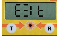
Diese Funktion ermöglicht das Verlassen des Master-Modus und leitet einen Display-Reset ein.
