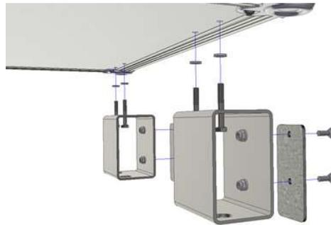
5. Befestigungsschrauben mit Unterlegscheiben und Sechskantmutter an der Schrankinnen-seite sichern.
