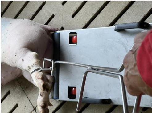
Mit einem Fuß wird Transporker fixiert und der Anwender zieht den Kadaver über die in der Rampe integrierten Aufnahmewalzen auf die Plattform. Mit der Zugstange wird nun Transporker mit dem Kadaver zum Kadaverplatz gefahren.
