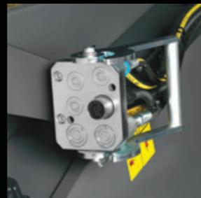
Die vorne im Schrägförderer angebrachte PowerFeed-Walze sorgt für einen konstanten Gutfluss vom Schneidwerk zum Schrägförderer. Die hydraulische Reversierung von Schneidwerk und Schrägförderer arbeitet bequem auf Knopfdruck.
