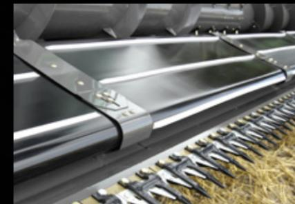
Für optimale Sicht und Leistung ist das Messer ganze 1,14 m von der Einzugschnecke entfernt. Die PowerFlow-Bänder nehmen das Erntegut hinter dem Messer auf und führen es aktiv und gleichmäßig zur Einzugschnecke. Die Bänder werfen Steine zurück aufs Feld, bevor sie in die Maschine gelangen und dort Schaden anrichten könnten.
