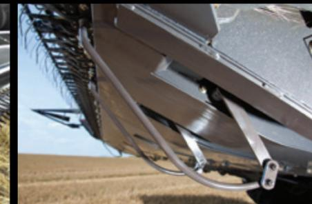
TerraControl II (FreeFlow oder PowerFlow) bietet einen Mix aus Absenk-, Schnitthöhen- und Auflagedruckautomatik – alle Einstellungen werden vom Fahrer bequem über den Fahrhebel aktiviert. Notwendige Anpassungen lassen sich schnell und einfach vornehmen, die gleichmäßige Zufuhr bleibt stets erhalten. Die Haspelautomatik entlastet den Fahrer, damit er sich auf die optimale Leistung der Maschine konzentrieren kann.
