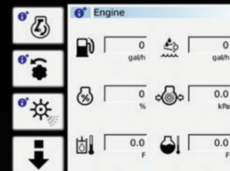
◀ Die Fenster im unteren Bereich des Terminals heißen Info-Plus-Bildschirme. Hier kann der Fahrer zwischen verschiedenen Bildschirmen auswählen, die detaillierte Informationen zu den Funktionen des Mähdreschers anzeigen. So erhält der Fahrer beispielsweise mit einem Blick Informationen zur Motor- und Wellendrehzahl und somit die Gewissheit, dass alle Systeme ordnungsgemäß funktionieren.
