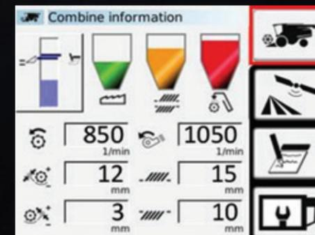
◀ Die gut ablesbaren Anzeigen auf dem Mähdrescher-Hauptmenü zeigen die Ist- und Sollwerte für die Höhe des Schneidwerks, den Kornverlust über die Strohschüttler und Siebe sowie die Überkehrmenge. Darunter befinden sich die aktuellen Einstellungen für Schneidwerkhöhe, Trommeldrehzahl, Dreschkorböffnung vorn/hinten, Gebläsedrehzahl und Sieböffnung oben/unten. Über Schnellzugriffstasten auf den Symbolen können die entsprechenden Einstellungen schnell und einfach geändert werden.
