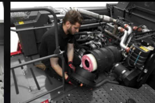
Überprüfen und Reinigen des Luftfilters
