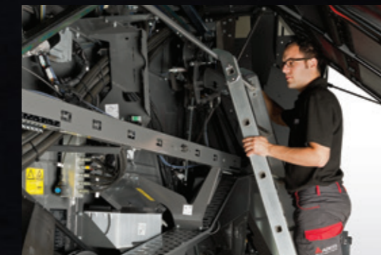
Leiterschienen für eine einfache und sichere Inspektion
