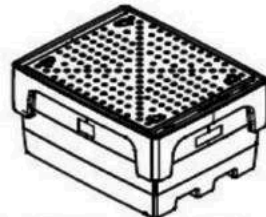
Typ 7 (Einfachstation mit Stützkreuz und PE-Lochplatte, 1000 l)
