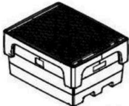
Typ 1 (Einfachstation mit Stützkreuz und Stahlgitterrost, 1000 l)
