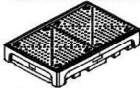
Typ 9 (Doppelstation mit Stützcross und PE-Lochplatte, 1000 l)
