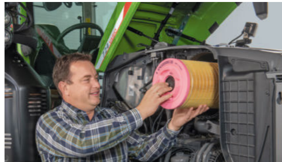
Der Motorraum ist durch die nach oben schwenkbare Motorhaube und die abnehmbaren Seitenteile besonders gut zugänglich. So lässt sich beispielsweise der Luftfilter schnell und einfach entnehmen.
