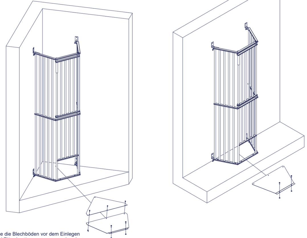
Bei Eckmontage die Blechböden vor dem Einlegen mit M6 x 16 und Flügelmutter zusammenschrauben.
