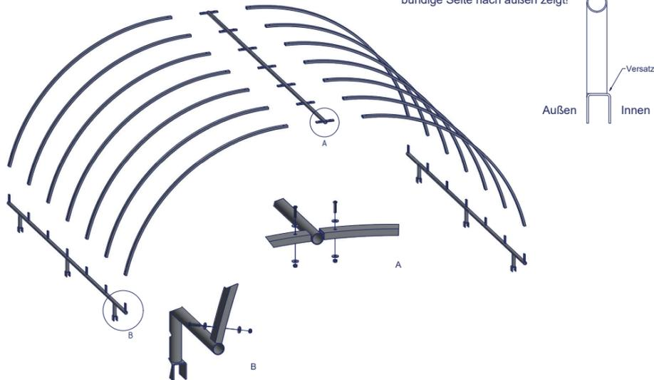
Die Panels aufstellen und miteinander verbinden. Die Dachkonstruktion auf die Panels setzen und die Plane überziehen. Die Plane an den Panels und im Boden befestigen.
