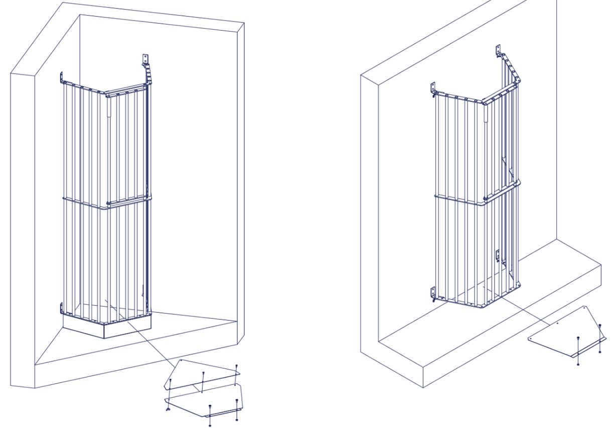
Bei Eckmontage die Blechböden vor dem Einlegen mit M 6 x 16 und Flügelmuttern zusammenschrauben.
