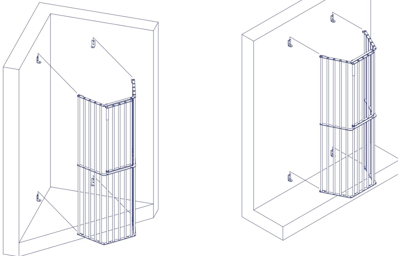
**5.** Zur Sicherung der Raufe den Federstecker in das Loch im Haken stecken.
