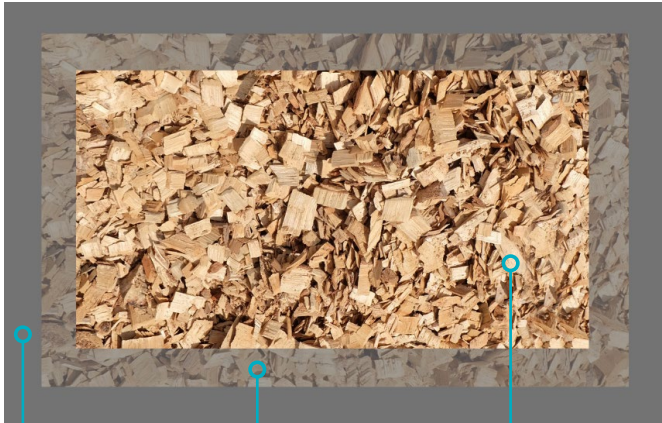
Überhang Vlies Vlies unter Holzhäcksel 10 cm Holzhäcksel
