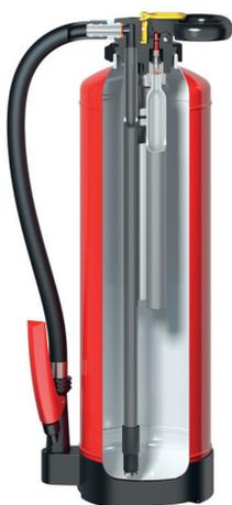
*Beim Aufladefeuerlöscher handelt es sich um ein Gerät, bei dem das Löschmittel und das Treibgas getrennt gehalten werden (siehe Schnittzeichnung Typ STAR mit innenliegender Treibmittelflasche). Erst kurz vor Inbetriebnahme wird die Treibmittelflasche über die Auslösearmatur geöffnet.*
