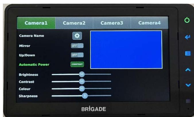
Bei Monitoren, bei welchen diese Möglichkeit nicht besteht, wie z.B. der **VBV-770HM [5611A]** sollte die Spannungsversorgung über einen zusätzlichen Adapter (**AC-24-12(011) [5760]**) hergestellt werden. Die Zuschaltung des Kamerabildes erfolgt weiterhin über den Triggereingang z.B. mit dem Rückfahrtsignal.
