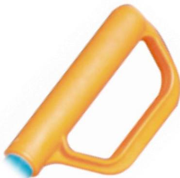
Den Griff in ein erhitztes Wasserbad (empfohlene Temperatur zwischen 75°C und max. 80°C) ohne Zugabe weiterer Mittel legen. Dadurch dehnt sich der Kunststoffgriff aus und kann einfach an den Geräten montiert werden. Beim Abkühlen zieht sich der Griff wieder zusammen und ist danach fest am Gerät montiert.
