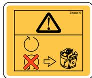
Achtung, Drehrichtung des Motors beachten, falsche Drehrichtung führt zum Bruch der Pumpe!
