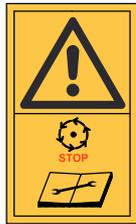
Instandsetzungs-, Einrichtungs-, Wartungs- und Reinigungsarbeiten nur bei abgeschaltetem Antrieb und stillstehenden Werkzeug vornehmen!
