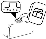
Den Kraftstoffbehälter nicht bis zum Überlaufen füllen, sondern ca. 5 mm Raum freilassen, damit sich der Kraftstoff ausdehnen kann.
