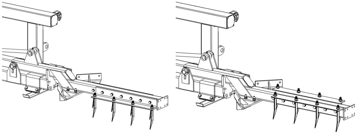
Das Gerät lässt sich im Betrieb hydraulisch in Arbeitsposition schwenken. Aus diesem Grund ist der Aufenthalt im Arbeits- und Schwenkbereich strengstens untersagt.
